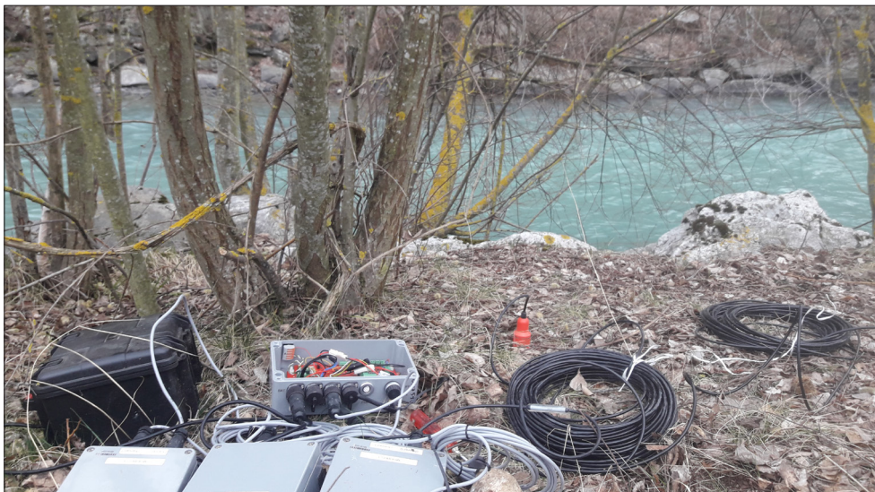
Géophones mesurant en continu les vibrations générées par le transport sédimentaire dans les rivières
